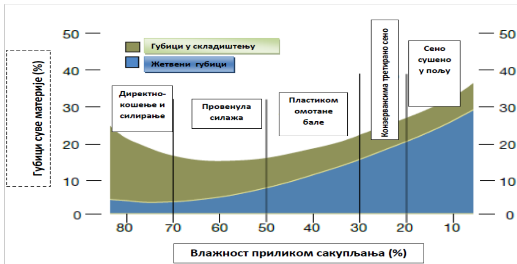
Сл. 3. Губици суве материје луцерке током конзервусања и складиштења (извор: Undersander i sar., 2004).
